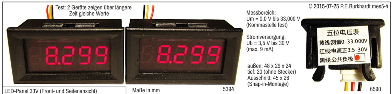
LED-Panel 33V (Front- und Seitenansicht)
