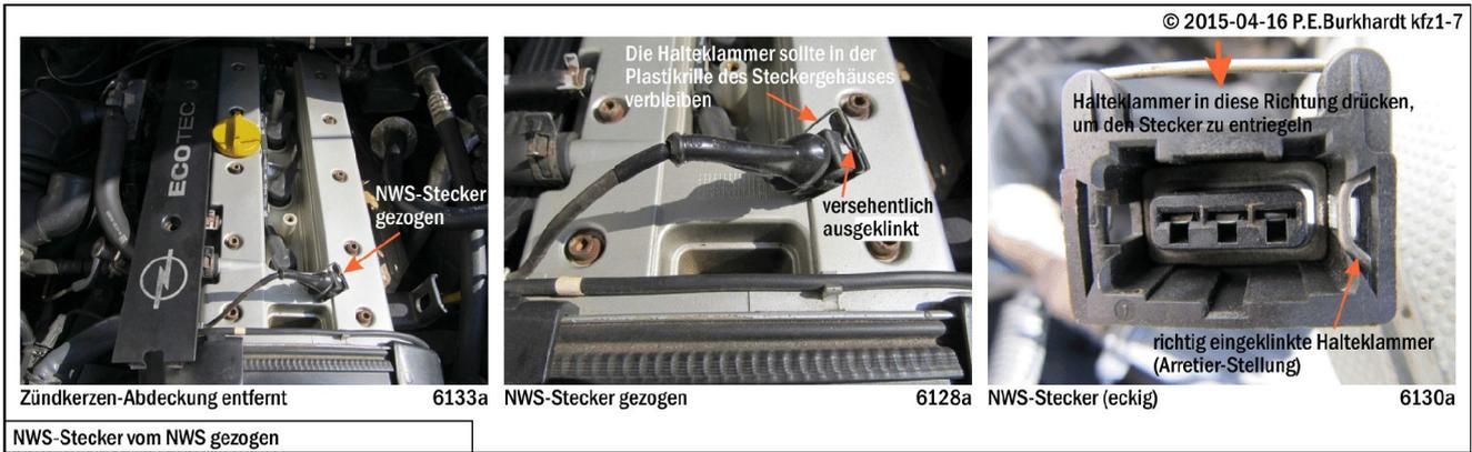
Der NWS-Stecker muss entriegelt werden, erst dann lässt er sich von den Kontakten des NWS abziehen. Zum Entriegeln ist ein Schraubendreher gut geeignet. Die Halteklammer des Steckers muss gegen den Steckerkörper gedrückt werden. Dann lässt sich der NWS-Stecker leicht abziehen.
