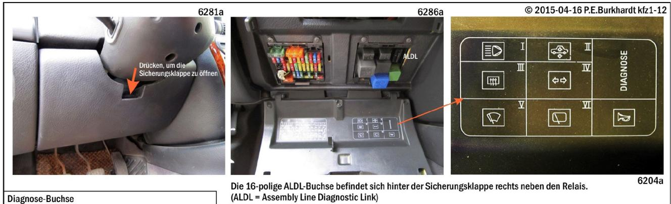
Die Kontakte der ALDL-Buchsenleiste (siehe folgendes Bild) können sich durch eine zu dicke Brücke so verbiegen, dass es beim Anstecken eines originalen Diagnose-Geräts zu Kontaktproblemen kommt. Eine dünne U-förmige Metall-Büroklammer (abgekniffen oder zurechtgebogen) hat sich bewährt.
