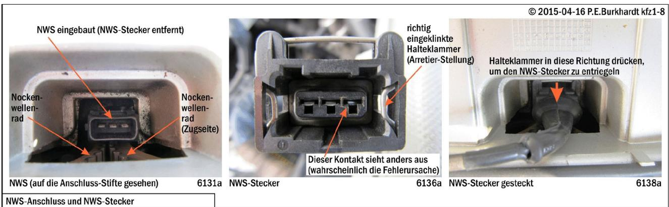
Beim Betrachten der NWS-Stecker-Kontakte (3-polige Buchsenleiste) fiel auf, dass ein Kontakt anders aussah. Es war zu vermuten, dass dieser Kontakt fehlerhaft war. Nach dem Justieren aller drei Kontakte der Buchsenleiste und Behandlung mit Kontaktspray wurde folgender Test durchgeführt:
