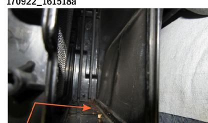
Schmutz vor Einbau des neuen Filters mit Staubsauger entfernen
