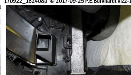
Fertig eingebauter Filter, nur die Abdeckung fehlt noch
