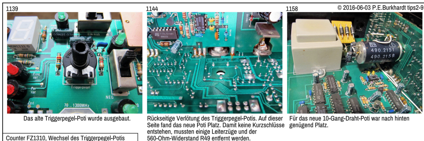
Counter FZ1310, Wechsel des Triggerpegel-Potis
