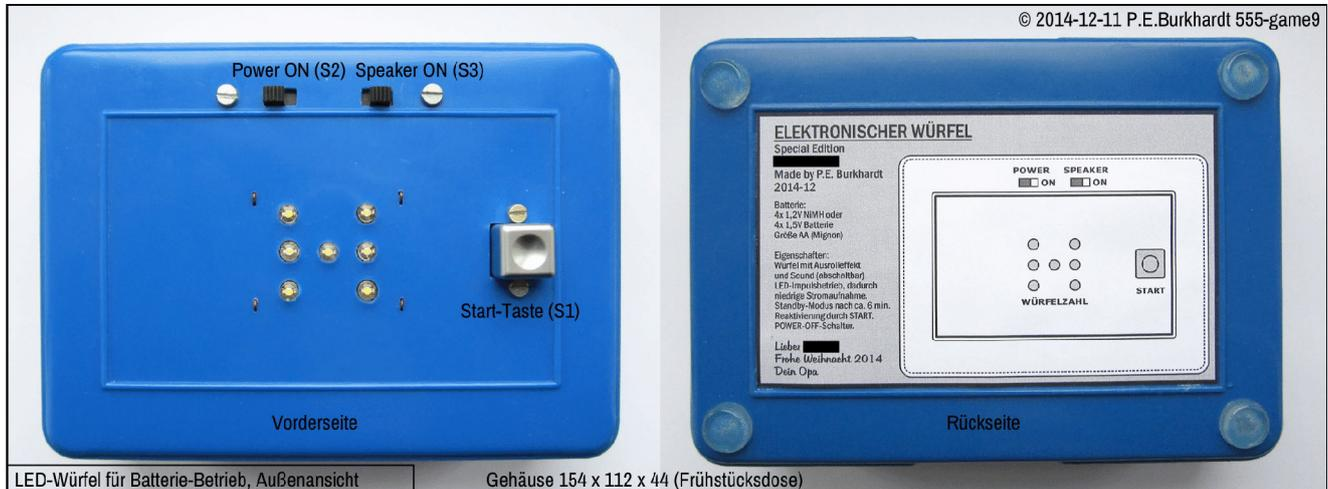
Im obigen Bild ist auch die Befestigung der LED-Leiterplatte zu sehen. Auch hier wurde einfach 0,8mm-Cu-Lackdraht durchgefädelt und umgebogen. Die Schiebeschalter stammen aus einem alten Taschenradio, der Taster ist eigentlich ein Netz-Tastenschalter. Damit ein Taster daraus wird, habe ich die Rückhaltung am Schaltermechanismus entfernt.
