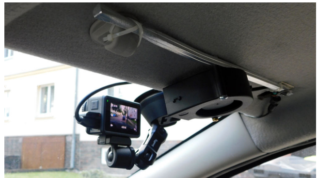
Der günstigste Dashcam-Einbauort, mit Lüfter
