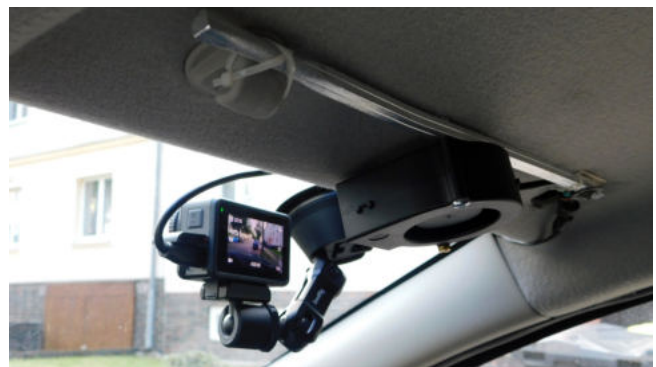
Der günstigste Dashcam-Einbauort, mit Lüfter
