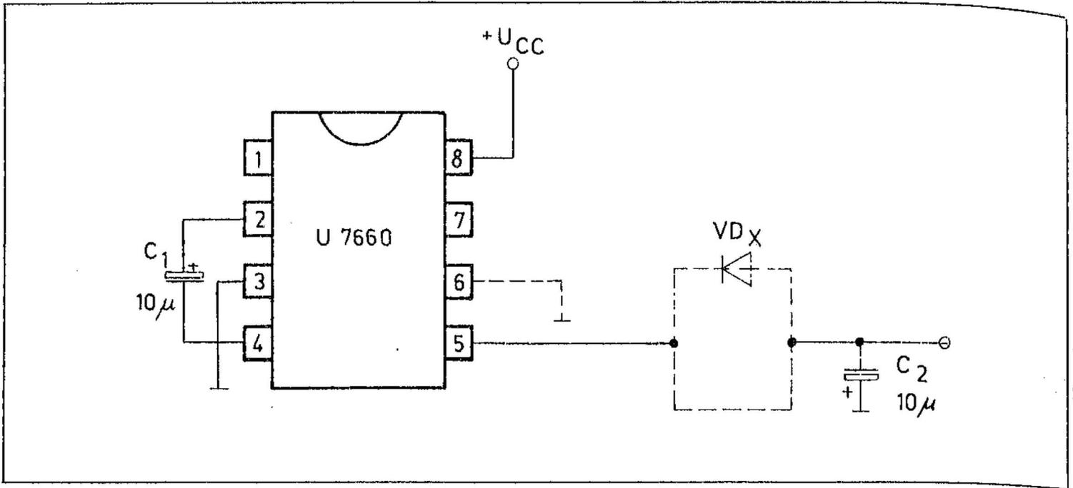
Applikationsbeispiel: Einfacher Spannungsinverter
