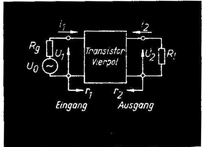
Transistorvierpol mit eingangsseitiger Spannungsquelle und ausgangsseitigem Lastwiderstand.
