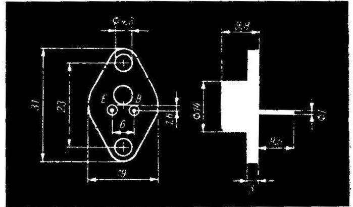
**Wärmewiderstand**  $R_{thi} \leq 7,5 \frac{\text{grad}}{\text{W}}$
