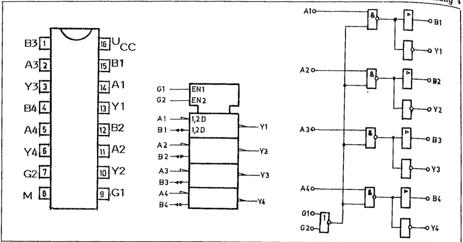
Anschlußbelegung, Schaltzeichen, Übersichtsschaltplan Bauform: DIP-16, Plast (Bild 4)
